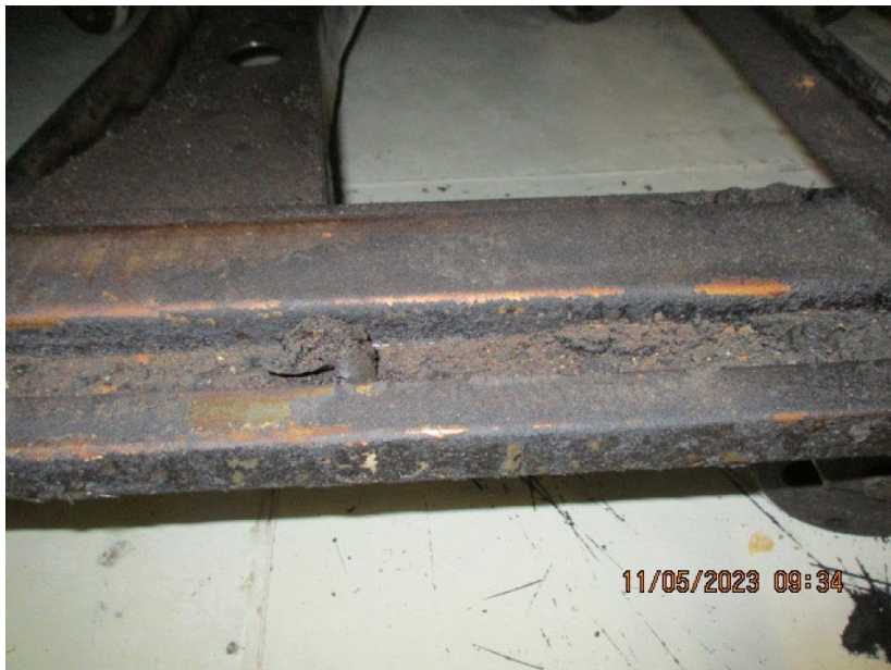
Obr. č.4 – ÚK 11.05.2023 – Tri stojany s uloženými pekářskými výrobkami v spodnej časti znečistené hrubou vrstvou zmesi oleja a zapečených pekářských zvyškov.
