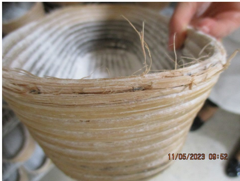
Obr. č.3 – ÚK 11.05.2023 – 15 kusov ošatiek poškodených a s výskytom uvoľnených vlákien.
