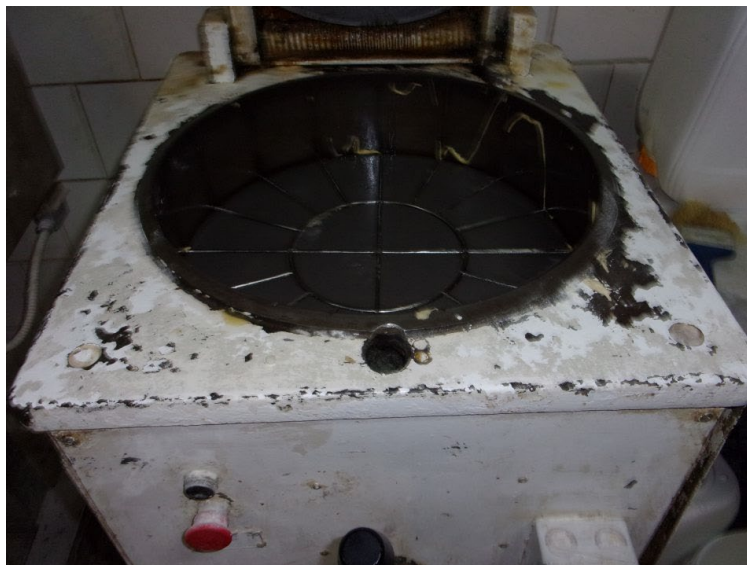
Obr. č.4 – ÚK 24.04.2023- Poškodený hygienický náter deličky.
