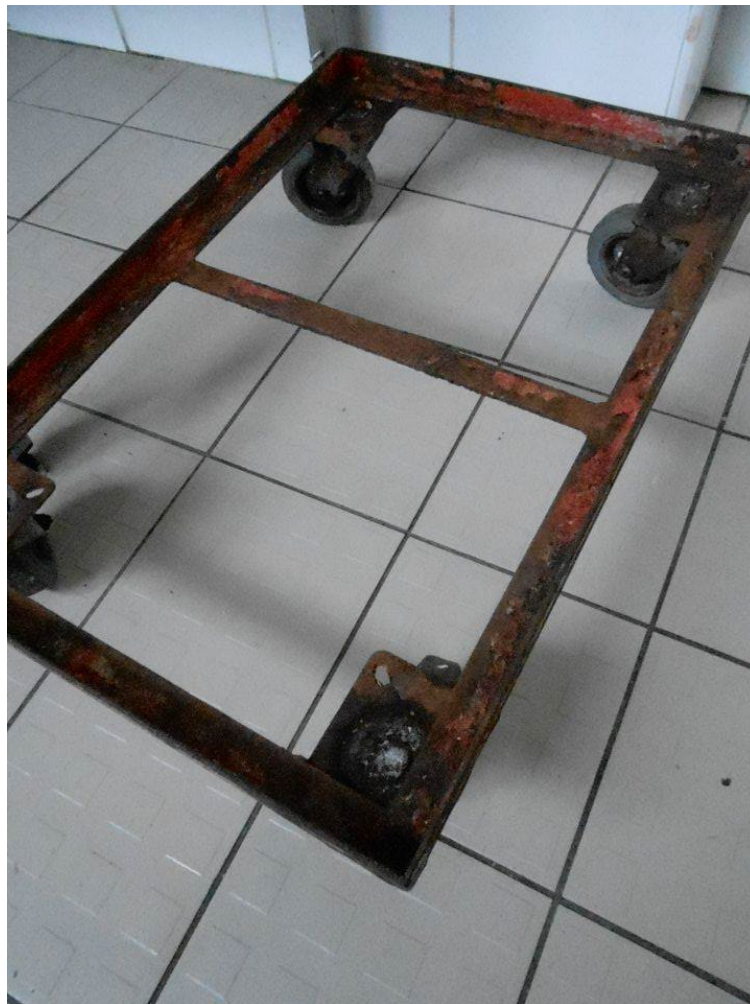
Obr. č.1 – ÚK 18.04.2023 - Náter kovového technologického zariadenia necelistvý, silne znečistený a skorodovaný.
