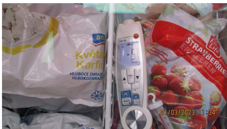
Obr. č.1 – ÚK 01.03.2023 - Nedodržený teplotný režim pri predaji hlbokozmrazených potravín.
